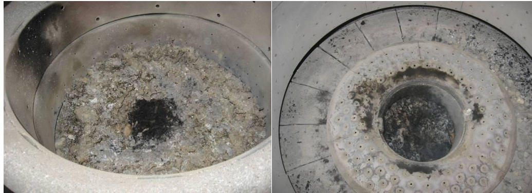
Foto 3: Cremador amb escòria i pedres Foto 4: Cremador d'astella lliure d'impropis. I. López
