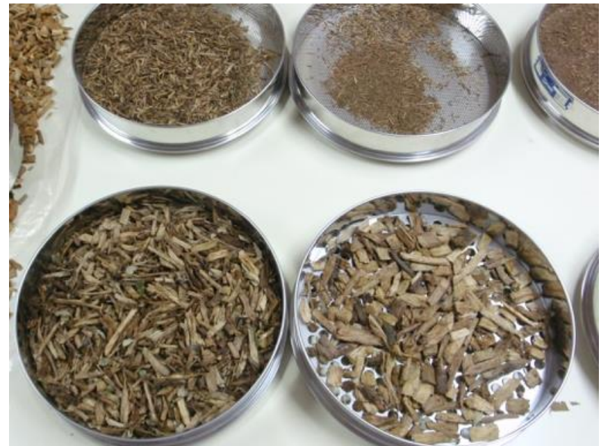
Foto 2: Prova de granulometria d'estella amb diferents mida de sedassos
